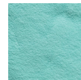
硫酸镍晶体 - 粒径小于0.25mm
