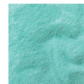
硫酸镍晶体 - 粒径0.25-0.38mm
