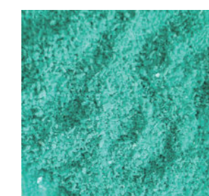
硫酸镍晶体 - 粒径大于0.50mm
